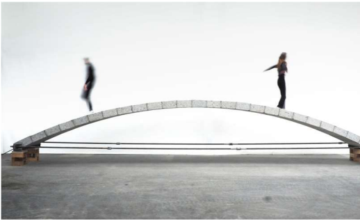
Bögen bilden die ideale Tragstruktur für die Wiederverwendung von Betonblöcken, da das Material nur Druckkräften ausgesetzt ist. Quelle: zvg
